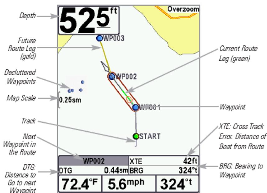
Надписи на рисунке слева снизу вверх по часовой стрелке: Дистанция до следующего пункта назначения; Следующий пункт назначения в маршруте; Курс; Масштаб карты; Разреженный пункт назначения; Будущий маршрутный участок (золотой); Глубина;
