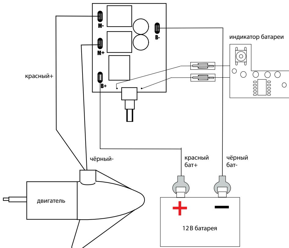
Моторы Endura оборудованы индикатором батареи. Он отображает уровень оставшегося заряда аккумулятора. Работает при выключенном двигателе.
