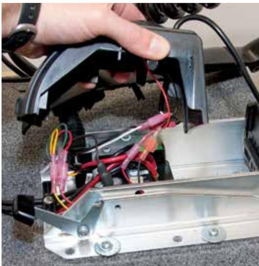
14. Удалите центральный элемент корпуса, нажимая на него с двух сторон и вытягивая из корпуса. Данная процедура откроет доступ к основному пункту управления и кабелям. (Рисунок 24).
